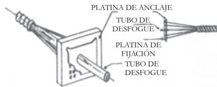
Es un anclaje en forma cónica. Las cabezas de los alambres descansan sobre una placa metálica. Los alambres están expuestos en todo extremo de modo que cuando el concreto se inyecta los alambres se adhieren formando un sólido bloque de anclaje.
