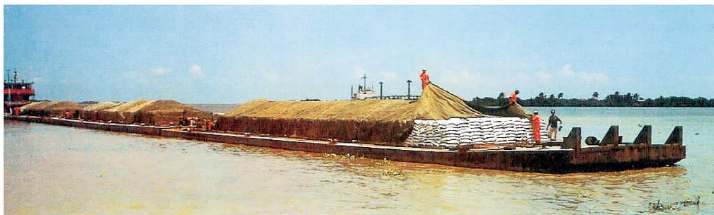
**Fotografía No. 47.** Convoy de barcazas con carga a granel.
